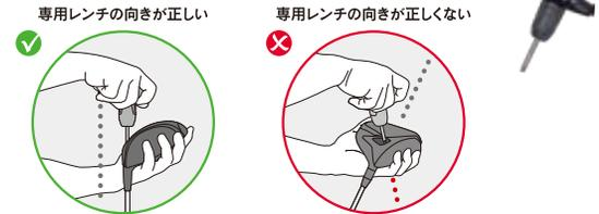
専用レンチを必ずシャフトと一直線になるように合わせ、正しく挿入してネジを締める、または緩めるようにしてください。ネジは脱落防止用ゴム製ワッシャーによりヘッド内に残っています。ネジは締めつけられることなく滑らかに入るようにします。ネジが固い、あるいは回りにくい場合は、一旦組み立てを中止し、最初からやり直してください。ネジを無理に回すと、ネジ山を損傷する恐れがあります。
